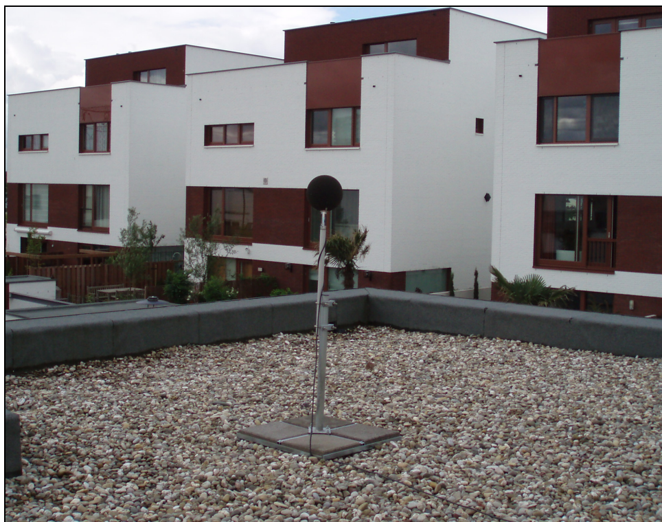
Figuur 3: Meetopstelling op dak woning klager
